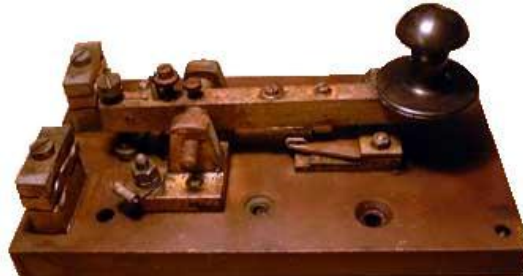
figuur 4.1 De Morse sleutel waarmee elektrische pulsen worden verzonden
